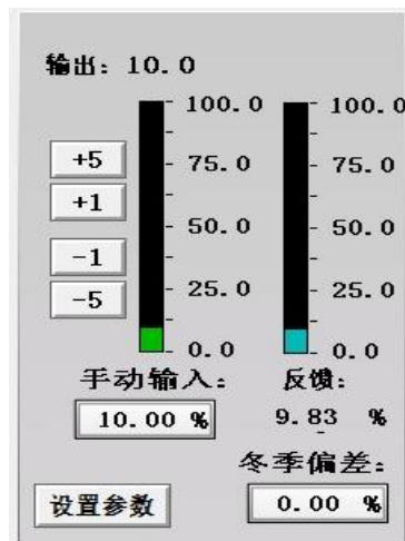
图5 改造后冬季防喘振阀偏差图
