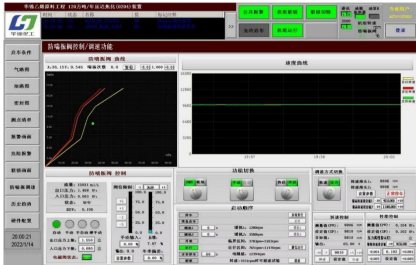
图 2 改造后调速控制面板总貌
